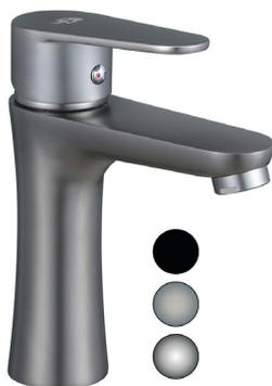
Miscelatore monocomando lavabo con cartuccia diam. 35 mm; fornito con 2 tubi flessibili per alimentazione di cm 40 - G3/8". Completo di piletta di scarico da 1"1/4.
